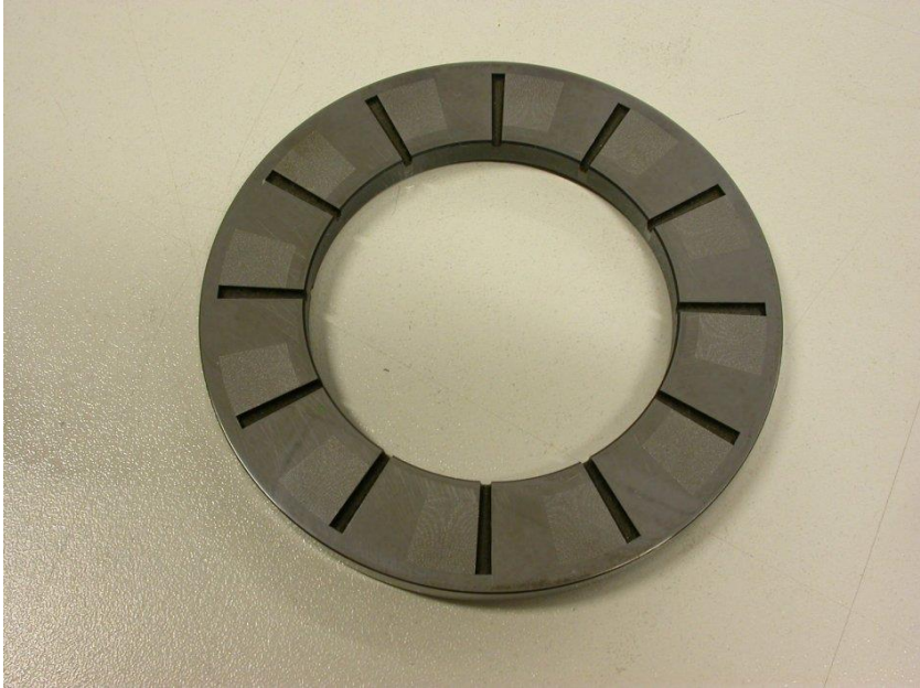
Figura 21 Lagăr axial parțial texturat cu ajutorul tehnologiei laser [63]
